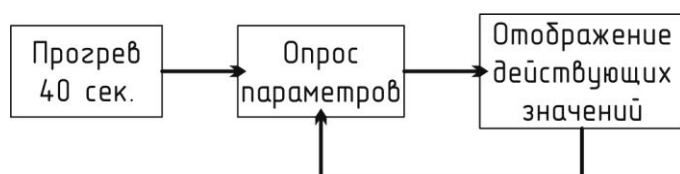
Рис. 4. Блок-схема работы газосигнализатора.
